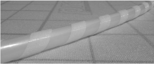
Das protec KLETT-Heizrohr PE-RT ist ein hochflexibles Kunststoffrohr mittlerer Dichte, hergestellt gemäß DIN und sauerstoffdicht ummantelt nach DIN 4726. Die Kletteigenschaft erhält das Heizrohr durch die spiralförmige Umwicklung des Außenrohres mittels Mikroklettband
