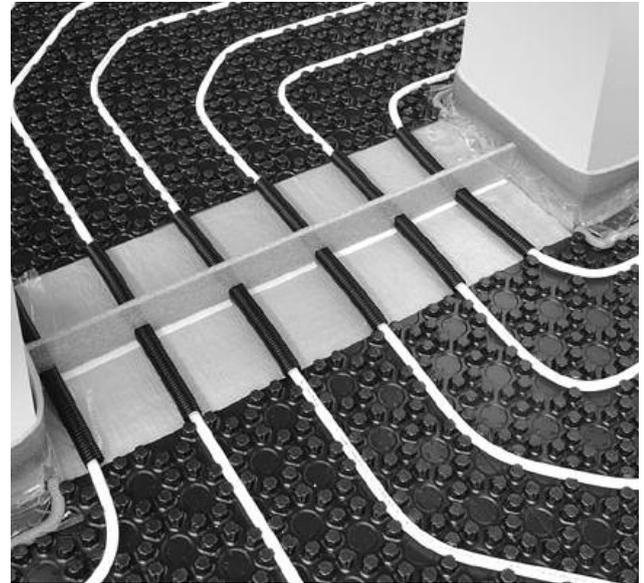
Die protec Noppenplatten U verfügen über ausgeschäumte Rohrhaltenoppen mit aufgesteckter, vakuumverformter Tiefziehfolie zur Arretierung der Heizrohre zwischen den Noppen. Die Geometrie der Noppenoberfläche ermöglicht die axiale und diagonale Verlegung der Heizrohre. Die Verbindung der Noppenplatten erfolgt nach dem Druckknopfprinzip.
